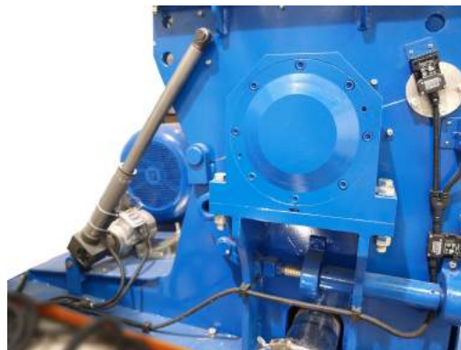
Accionamiento eléctrico de la tolva y seguridades de Pegaso 4
