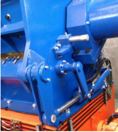
Apertura de la tolva y del cuerpo mediante cilindro hidráulico
